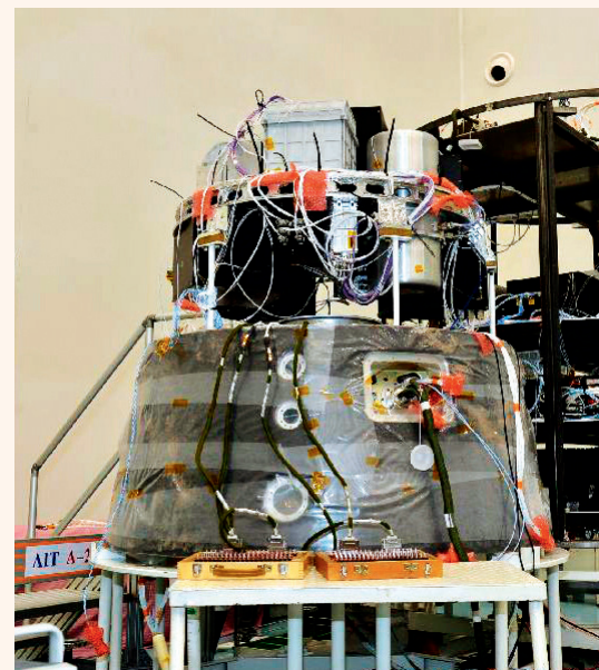
实践十号返回式科学实验卫星在总装测试中 摄影/陈益宸
